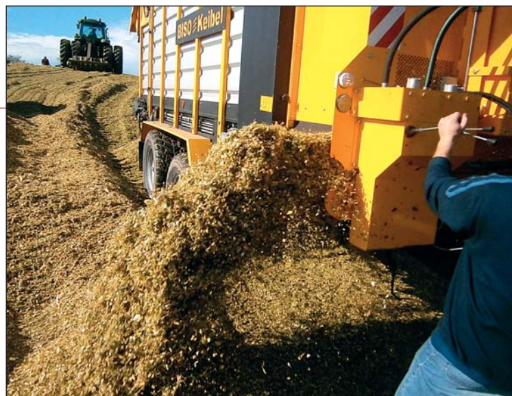
Krmný vůz FU 25 je možné použít i při odvozu rezačky. Rovnoměrné dávkování na levou či pravou stranu, nebo po otevření zadního čela přes frézovací válce, snižuje následné nároky na rozhrnování rezačky
