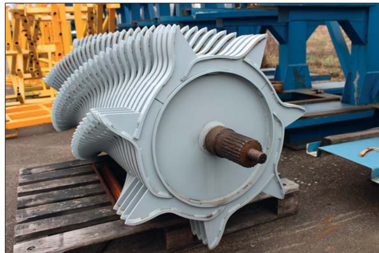
Řezací rotor je technologicky náročný na výrobu a musí být vyroben s velkou přesností
