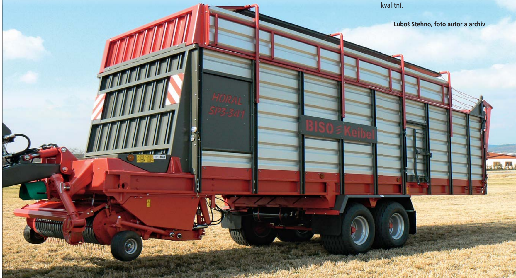
Sběrací vůz Horal SP3-341 se vyrábí s ložným objemem 40 nebo 52 m 3 podle DIN (60, nebo 79 m 3 při stlačení)
