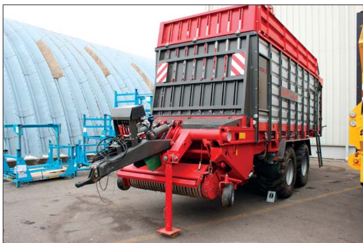
Horal 32 reprezentuje univerzální senážní vozy, které lze využít pro sběr a řezání sena, slámy, senáže i jako odvozní prostředek při sklizni kukuřice
