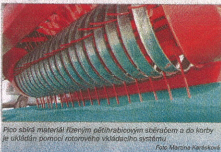
Stroj Pico, který byl prezentován na výstavě Techagro, je opravdovým unikátem. Jde o nesený sběrací stroj, jenž lze agregovat s traktorem od výkonu 30 kW. Foto: Martina Karásková
