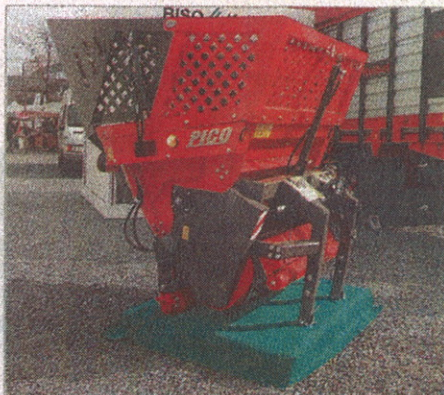
Stroj Pico, který byl prezentován na výstavě Techagro, je opravdovým unikátem. Jde o nesený sběrací stroj, jenž lze agregovat s traktorem od výkonu 30 kW. Foto: Martina Karásková
