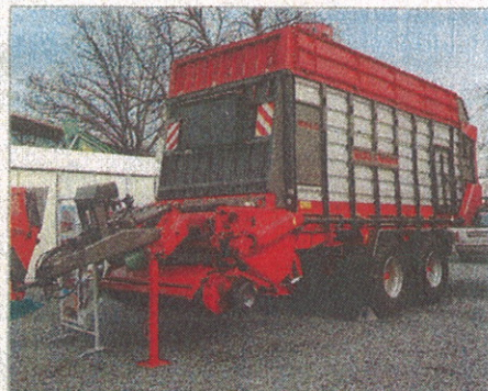
Dalším vystaveným strojem byl tradiční samosběrací kombinovaný vůz Horal 32, který je určen nejen ke sběru senáže, slámy či zavadilé píce, ale lze ho využít i pro vrchní plnění při práci s řezačkou. Foto: Martina Karásková
